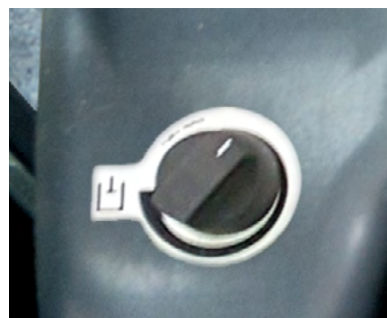
3 Potentiomètre de réglage fin du débit PTO
